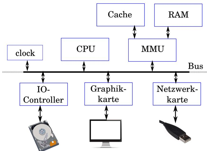
Ein sog. *Bus* dient als zentraler Kommunikationskanal zwischen den einzelnen Komponenten des Rechners. Über ihn laufen die Bitsequenzen. Meist gibt es aber nicht nur einen, sondern mehrere Busse, die verschiedenen Zwecken dienen. Insbesondere unterteilt man ihn in den *Datenbus*, über den die Daten laufen, und den *Adressbus*, über den die Adressen der Daten verschickt werden.
