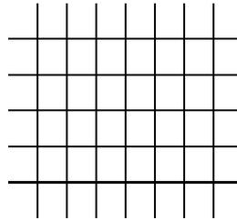
**Crossbar-Switches:** Dies ist auch eine gitterförmige Topologie. Aber die CPUs sitzen nicht an den Knoten des Gitters, sondern an den Enden der Gitterlinien. An den Knoten sitzen nur Switches, die die ankommenden Daten richtig weiterleiten. Diese Topologie eignet sich für sehr große Mengen an CPUs.
