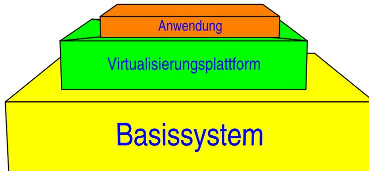
Ein bekanntes Beispiel ist die *Java Virtual Machine* (JVM). Sie lässt einen üblichen Prozessor aussehen wie einen Java Byte Code Prozessor. Die Java Virtual Machine bewirkt, dass jeder Befehl des Java Byte Codes direkt als Folge von Maschinenbefehlen des darunterliegenden Prozessors ausgeführt wird. Ohne ein kompiliertes Programm zu ändern, kann man dann das Programm auf ganz verschiedenen Prozessoren ausführen. Man braucht nur die für den jeweiligen Maschinencode angepasste JVM.
