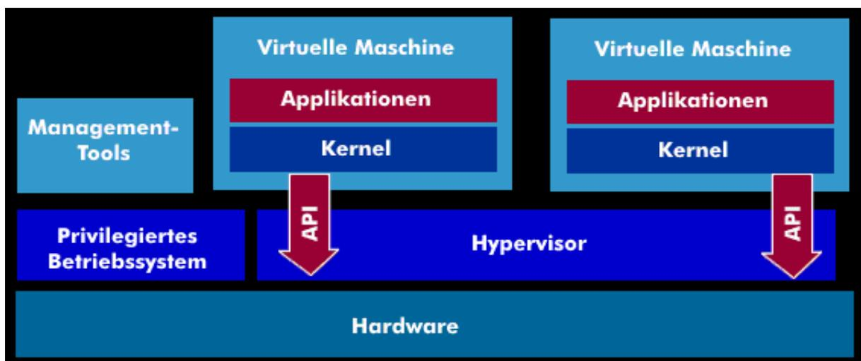
Der Hypervisor bestimmt, welches Betriebssystem gerade aktiv ist und sorgt dafür, dass die Betriebssystemaufrufe der Anwendungsprogramme auch von dem aktiven Betriebssystem ausgeführt werden.
