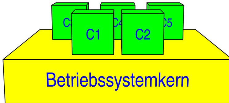
Da die Anwendungen direkt auf dem Prozessor laufen, gibt es kaum Performanzverluste. Die verschiedenen Containersysteme unterscheiden sich natürlich, auf welchem Betriebssystemkern sie laufen, aber auch wie die Sicht auf die Systemumgebung, insbesondere das Filesystem ist.
