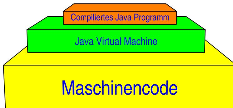
Virtualisierung ist also nicht eine Übersetzung (Compilation), wo eine Quellsprache in eine Zielsprache übersetzt wird, sondern die Anwendung wird unmittelbar ausgeführt, allerdings in einer simulierten Umgebung. Bei Programmiersystemen kennt man das schon lange in Form von *Interpretierern*. Ein Interpretierer für z.B. die Programmiersprache Perl führt den Perl-Code unmittelbar aus, ohne Übersetzung. Der Perl-Interpretierer schafft also für das Perl Programm eine virtuelle Perl Umgebung.
