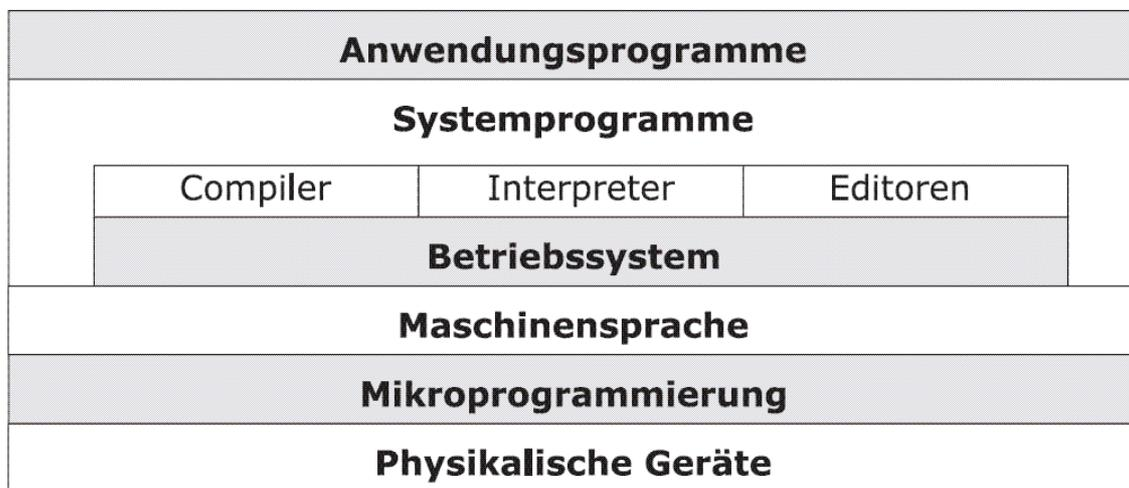
Ganz unten in der Hierarchie ist die Hardware mit Prozessor, Speicher, Festplatte, Monitor, IO-Kanäle usw. Einige der Geräte, insbesondere Prozessoren, lassen sich an bestimmte Anforderungen anpassen, indem einzelnen Maschinenbefehle per *Mikroprogrammierung* definiert werden. Nach außen hin hat jeder Prozessor eine festgelegte *Maschinensprache*, mit der er programmiert wird.
